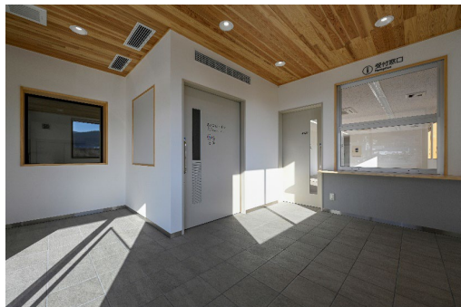
天井CLTあらわれし
