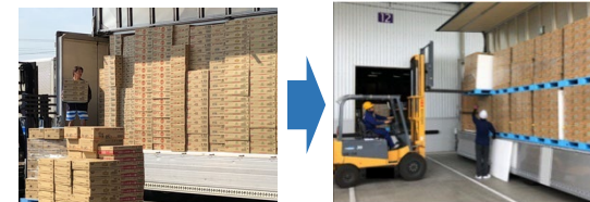
バラ積み・バラ降ろしによる非効率な荷役作業
